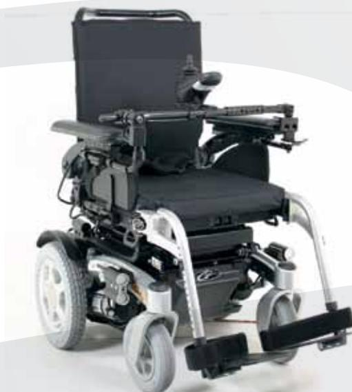
Joystick montato centralmente
