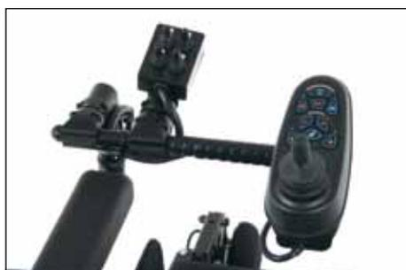
Joystick montato centralmente con scatola attuatori
