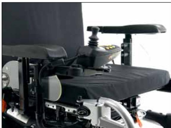
Joystick montato ruotato di 90°
